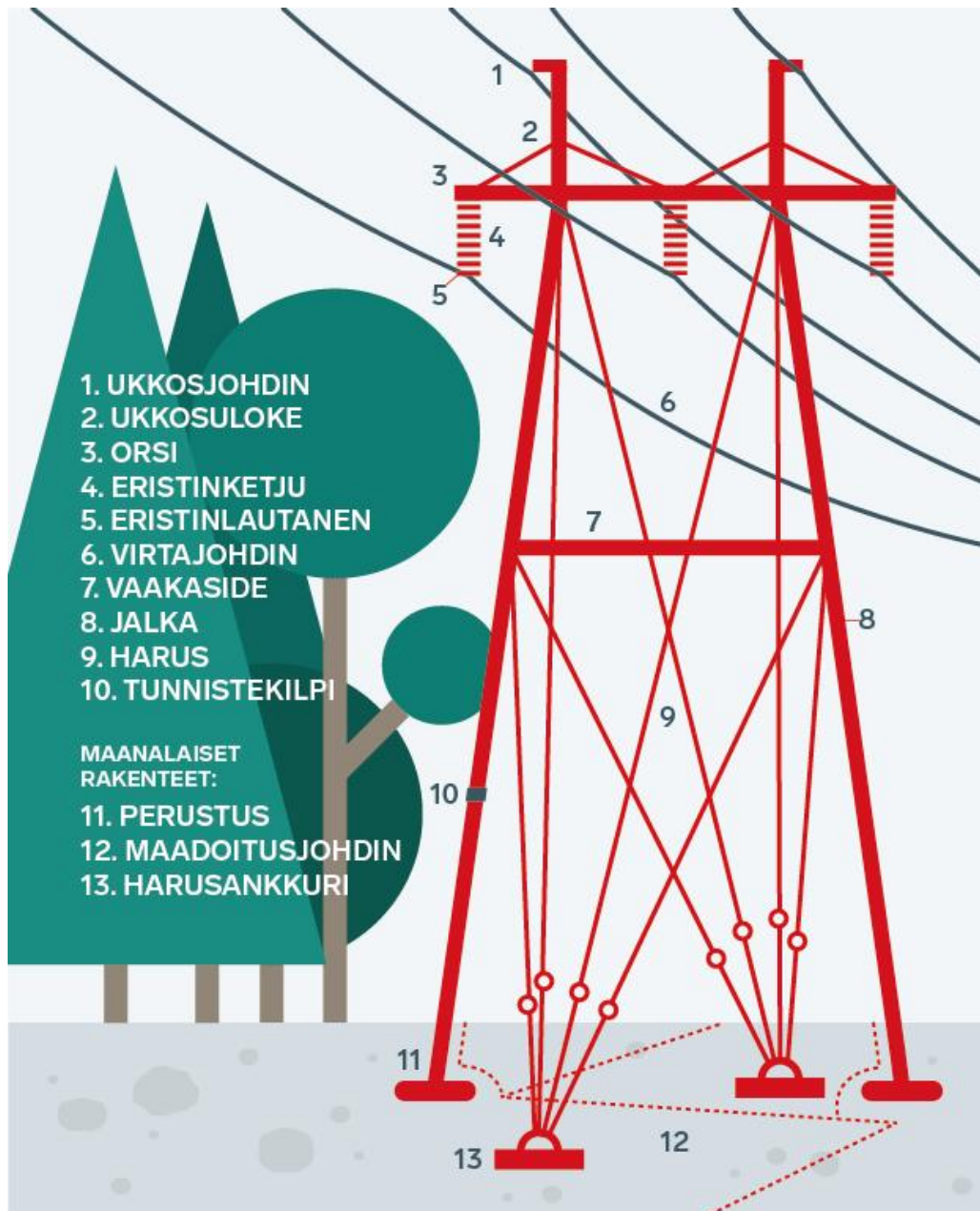
Kuva 7-5. Voimajohdon osat (Fingrid 2024b).
