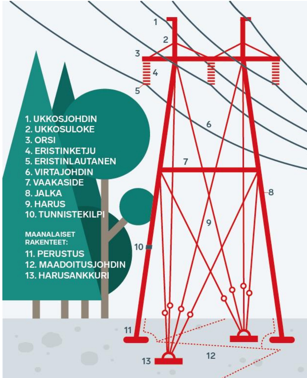
Kuva 7-5. Voimajohdon osat (Fingrid 2024).
