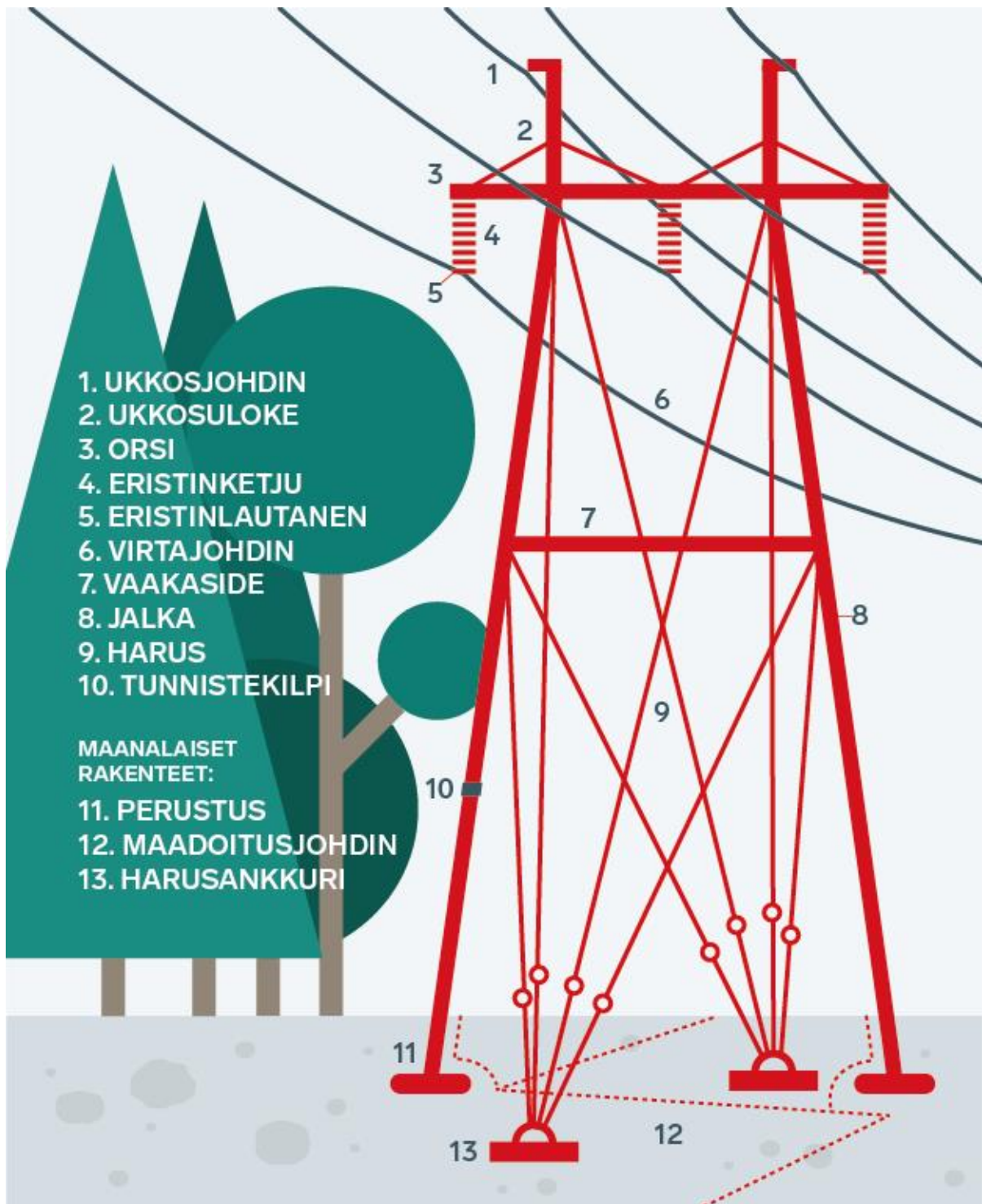
Kuva 2-7. Voimajohdon osat (Fingrid 2022a).
