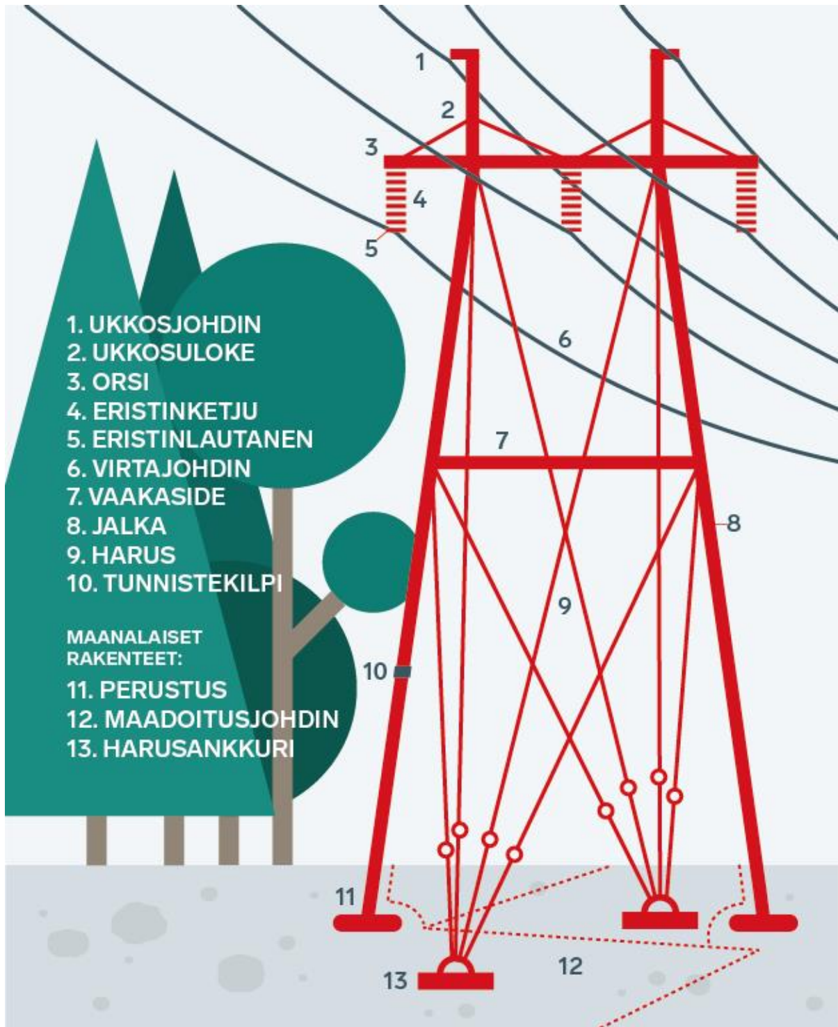
Kuva 2-7. Voimajohdon osat (Fingrid 2022a).
