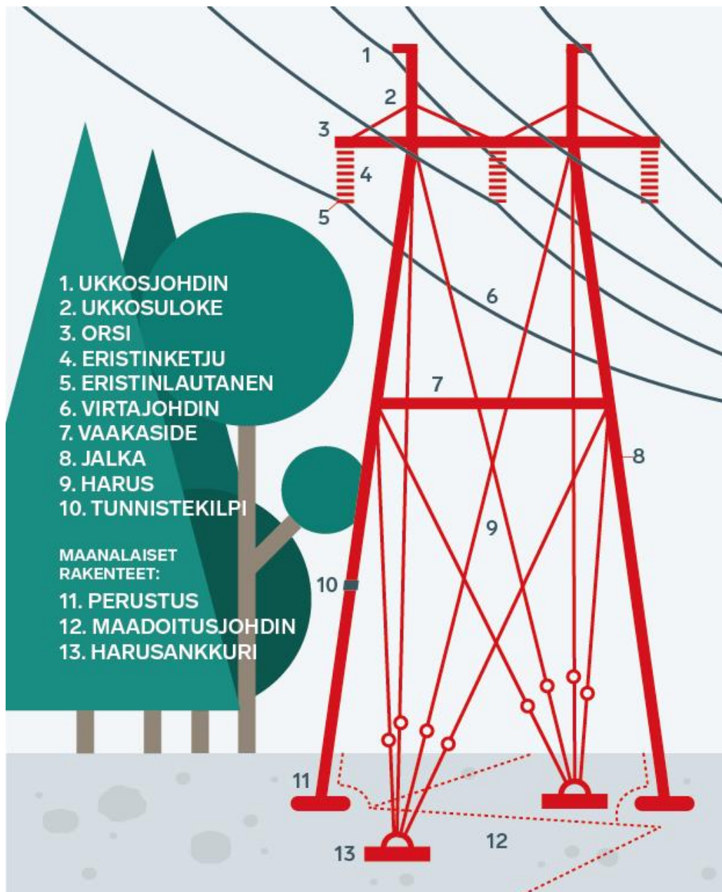
Kuva 7-5. Voimajohdon osat (Fingrid 2024b).
