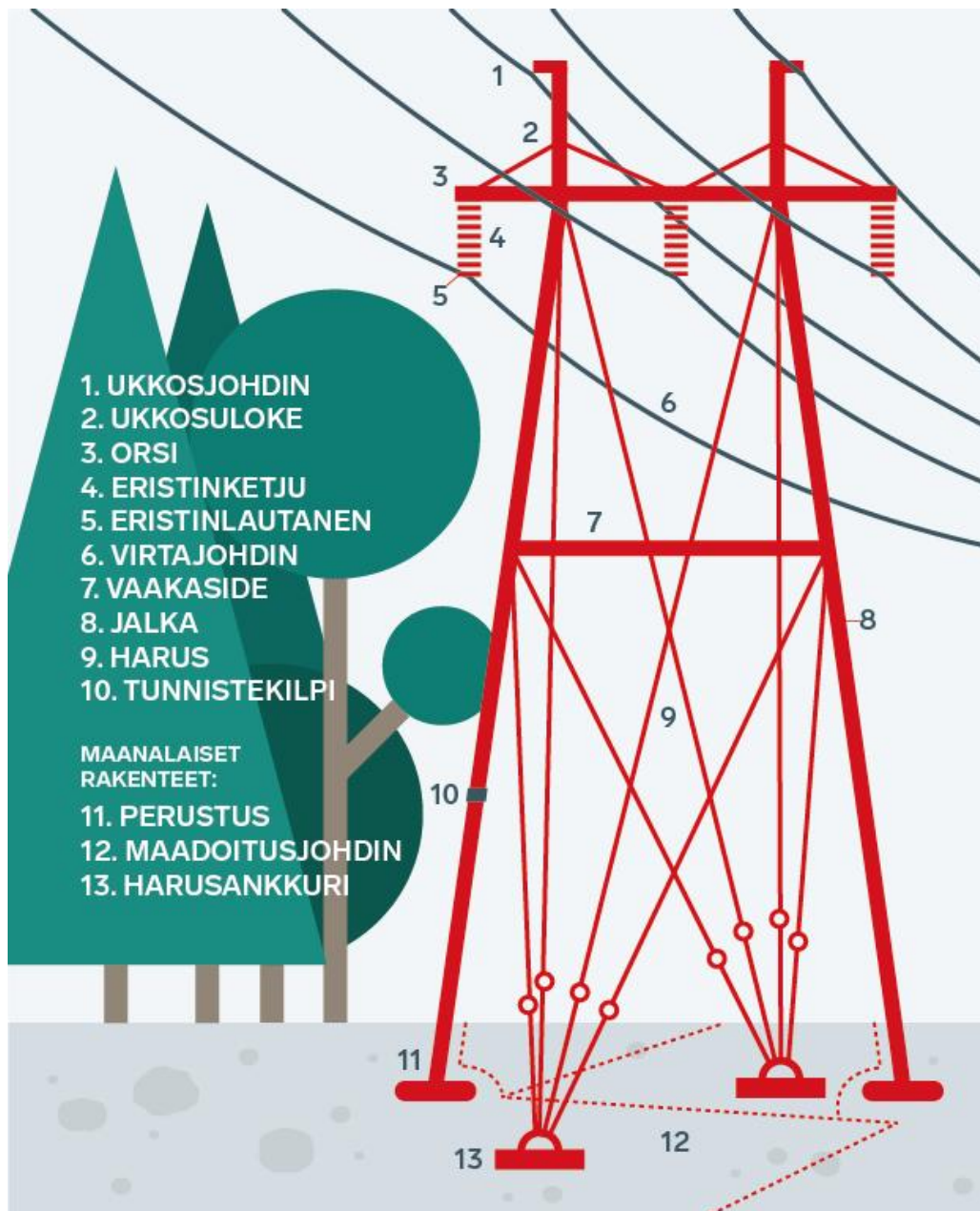
Kuva 7-5. Voimajohdon osat (Fingrid 2024).
